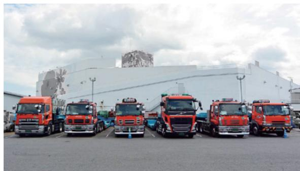
プラント部門、電設部門の多岐に渡る重量物・高価精密機器を輸送しています。振動を嫌う半導体製造機器の輸送にも、エアサスペンション装備車両を導入して、対応しています。
